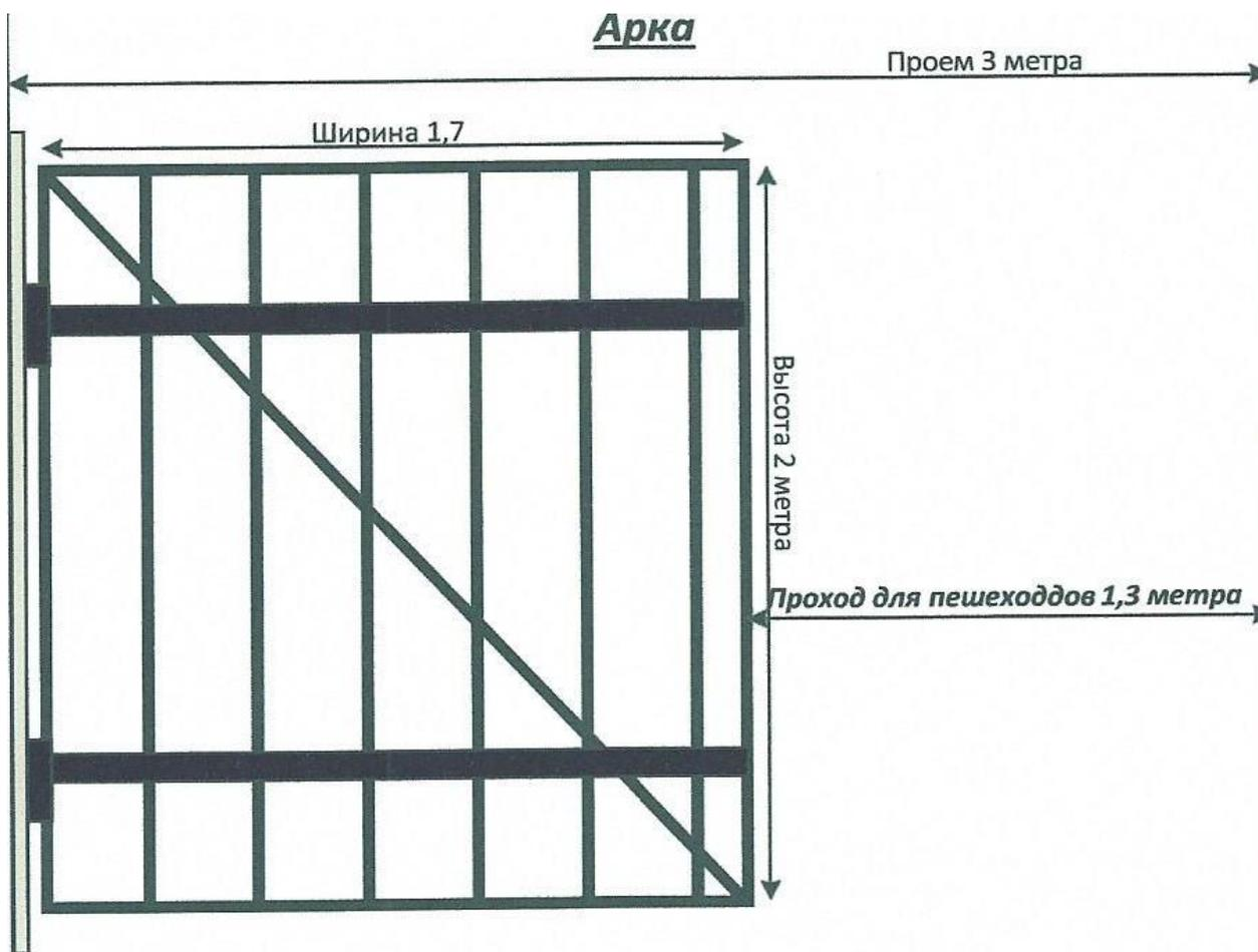
Ворота распашные, створка ворот с электромеханическим приводом открывания и закрывания створки. Створка оснащена комплексом оборудования: GSM-контроллером, памятью на 8000 номеров, блоком питания, SIM-картой, IP-видеокамерой, вызывным устройством с антивандальной панелью, блоком питания, модулем перезагрузки, приемно-передающим оборудованием, реле управления, светодиодным прожектором с датчиком освещенности
